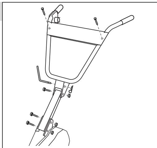
**Подготовка к работе****5. Регулировка высоты рукоятки**
