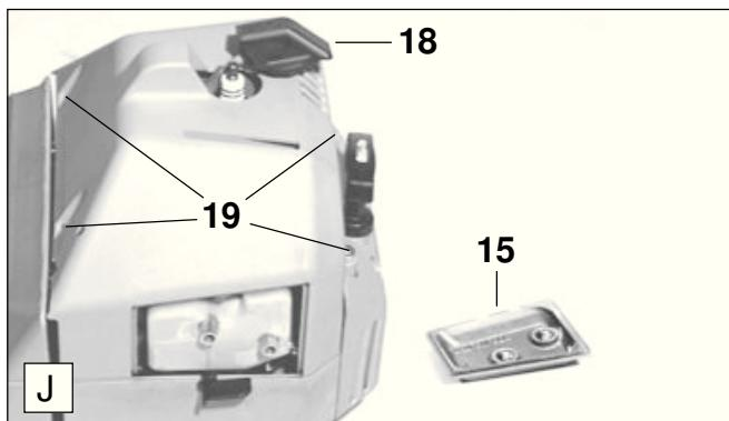
В случае повреждения изоляторов, при сильном обгорании электродов или при сильном загрязнении или покрытии жиром электродов необходимо обязательно заменить свечу зажигания.
