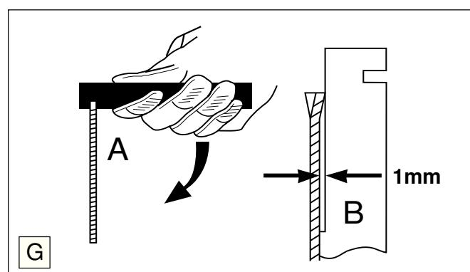
Если режущее полотно зажимается в разрезе, необходимо проверить разводку его зубьев.
