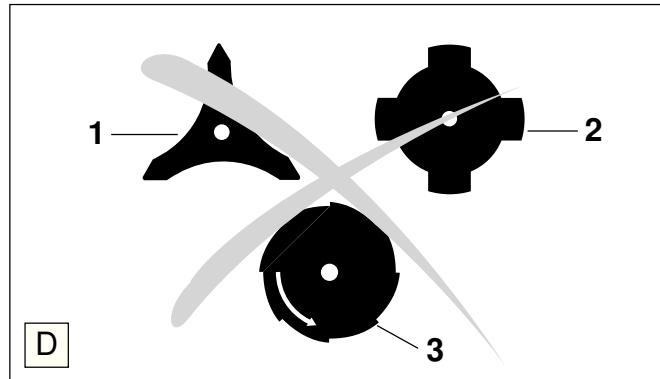
**Внимание:** Ниже перечисленный режущий инструмент может затачиваться только в специализированной мастерской, т.к. заточка от руки приводит к появлению небаланса режущего инструмента во время работы, ведущего в свою очередь к повышению уровня вибраций и повреждениям машинки.
