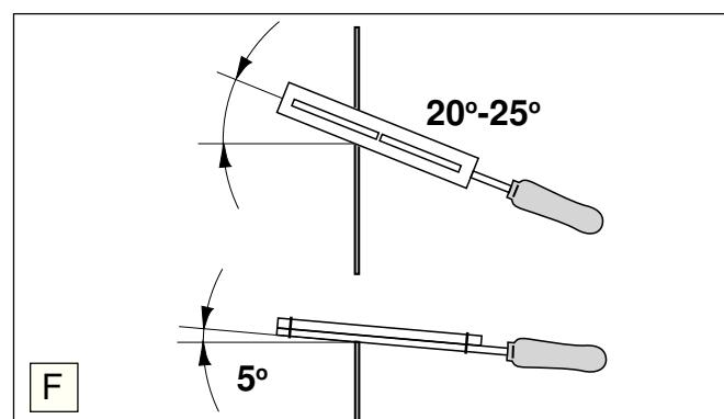
Следует обязательно выдерживать угол заточки в 20-25° (F). Для этого надо вести держатель напильника так, чтобы его маркировка была параллельна режущему полотну.
