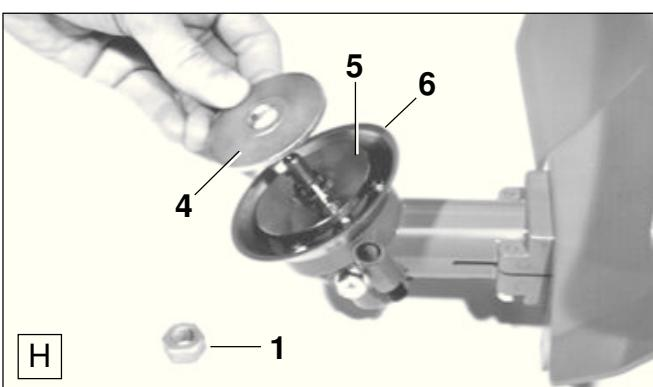
При использовании нитевой головки необходимо смонтировать защитный кожух с крепящей пластиной в положении (A) (см. раздел "Монтаж защитного кожуха")! **Нож для обрезания нитей должен быть вмонтирован обязательно** (см. раздел "Монтаж ножа для обрезания нити")!
