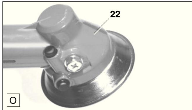
Углковый редуктор (O/22) наполнен смазкой длительного действия и поэтому не требует технического обслуживания. Если из углкового редуктора выступает большое количество смазки, необходимо обратиться в мастерскую фирмы MAKITA.
