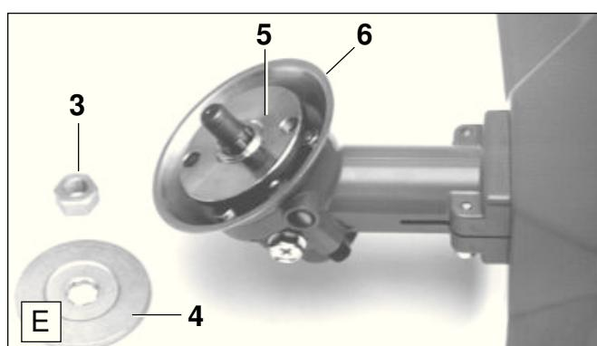
При использовании выше перечисленных режущих инструментов защитный кожух следует закрепить в положении (В) с помощью крепящей пластины (см. раздел "Монтаж защитного кожуха")!
