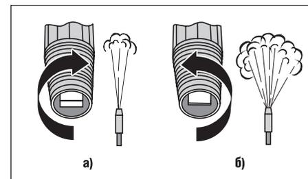
При необходимости обработки изделия или поверхности моющим средством, снимите крышку 13 бачка и, соблюдая рекомендованную производителем концентрацию, заправьте емкость моющим раствором. Установите струю низкого давления, нанесите моющее средство на обрабатываемую поверхность и оставьте действовать на 1–2 минуты, не допуская его высыхания.
