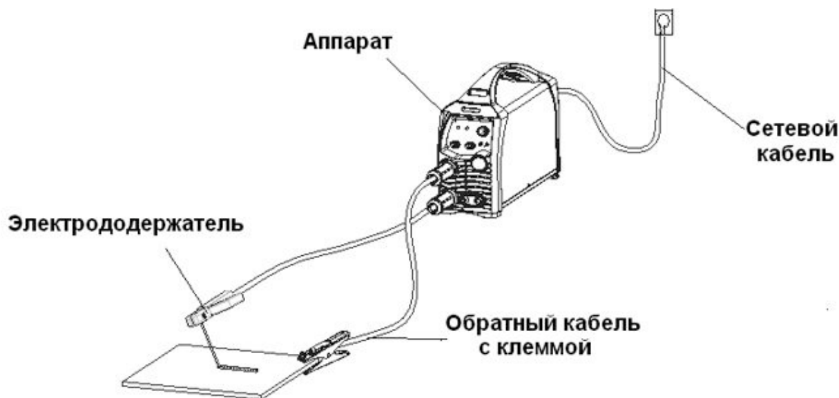
Рисунок 6.3 Схема подключения оборудования для ММА сварки.
