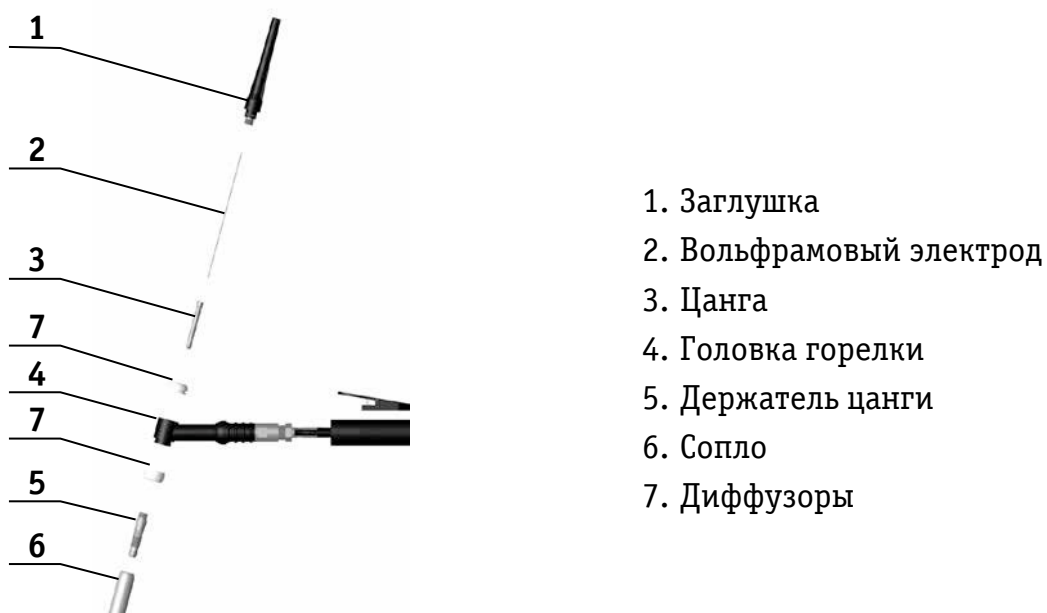
Рисунок 7.2.1 Основные компоненты горелки TIG
